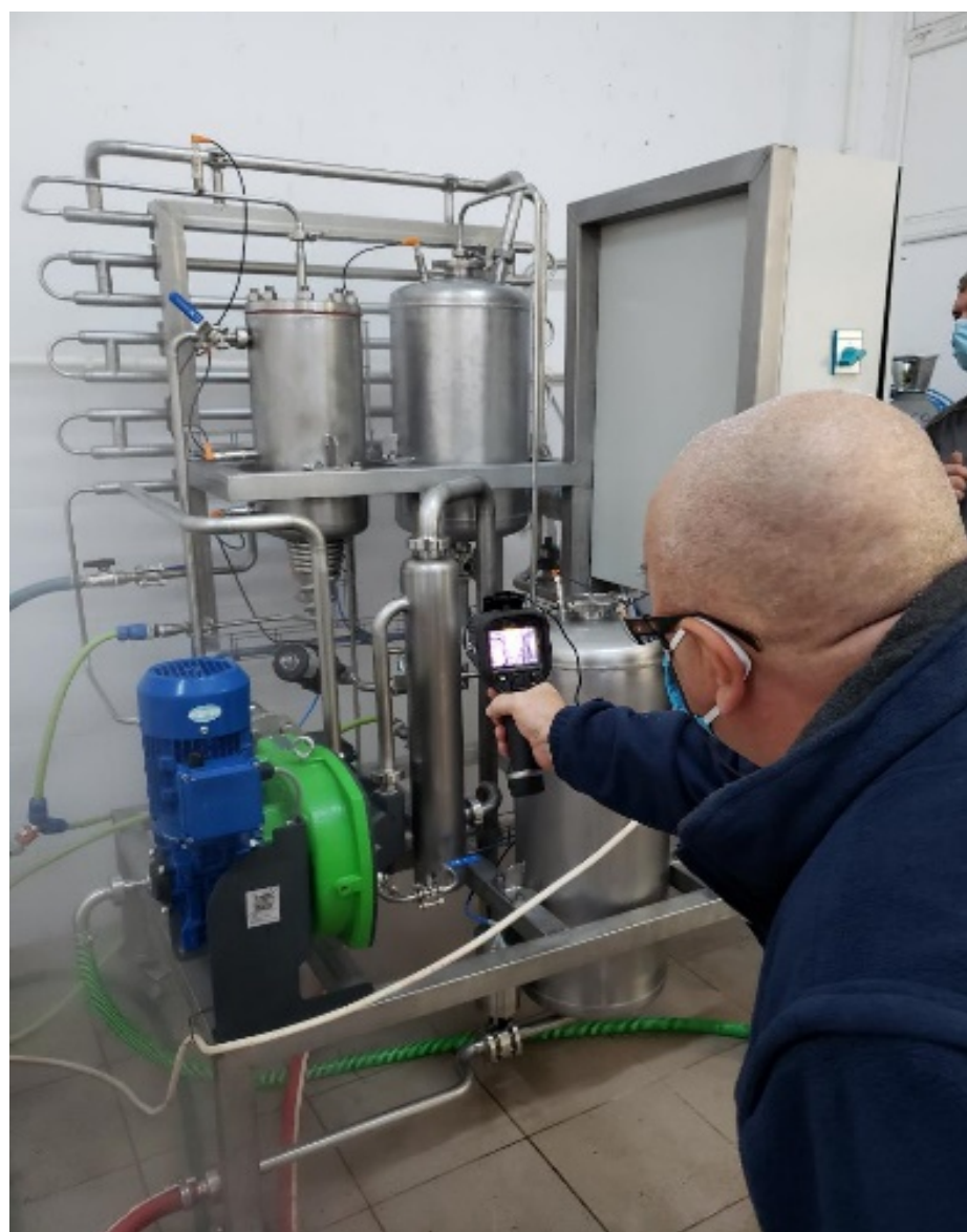
Efectuarea de măsurători cu camera de termoviziune
