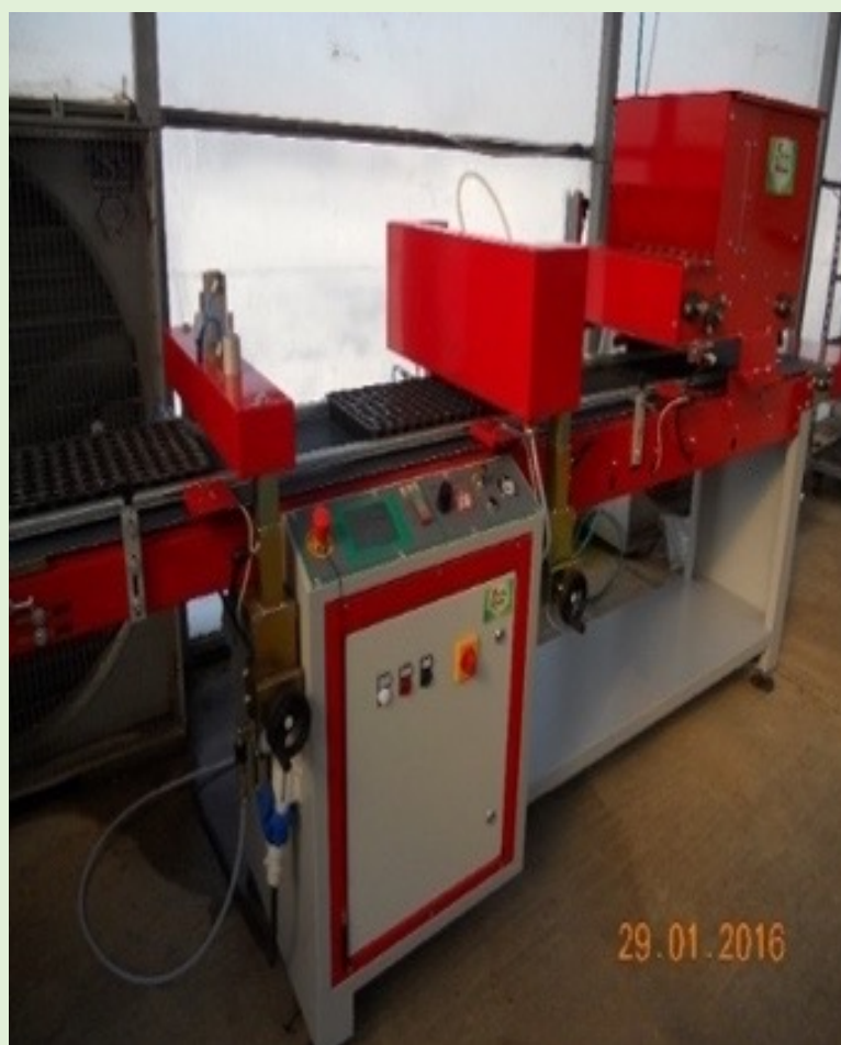
a) instalație însămânțat
